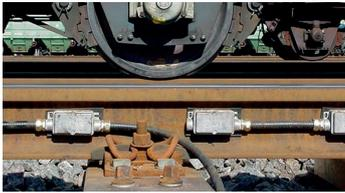
La surveillance des charges des trains améliore la sécurité ferroviaire et permet d'éviter toute usure inutile et prématurée des rails. Le système de pesage Silverpoint+ de Tamtron est utilisé pour surveiller le trafic ferroviaire et contrôler les surcharges. Le système pèse les trains et les wagons en mouvement. Le système pèse chaque roue, essieu, bogie et wagon et détecte le moindre déséquilibre entre les bogies ; il est donc également utile pour contrôler les erreurs de chargement.
